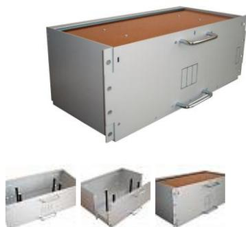
19" аккумуляторный блок «Форпост» 60В-4U предназначен для размещения 5 аккумуляторных батарей напряжением 12 В емкостью 16-18 А\*ч (с размерами 182x77x167 мм) и использования совместно с [источниками бесперебойного электропитания \(ИБЭП\) постоянного тока «Форпост»](#) 19" конструктива с выходным напряжением 60 В.
